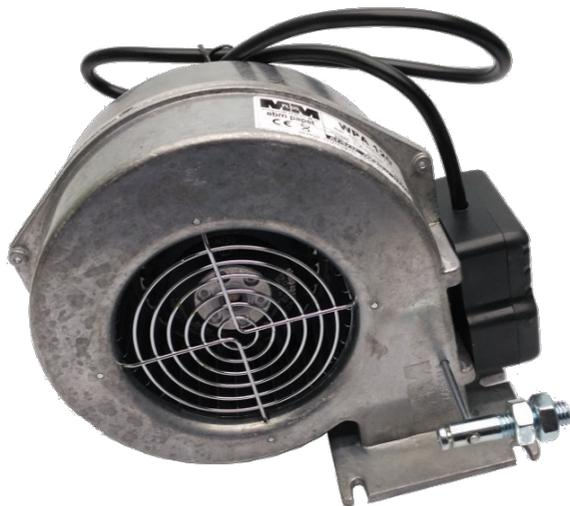
1. Вентилятор состоит из алюминиевого корпуса, в которой установлен двигатель с крыльчаткой. Впускное отверстие защищено сеткой. Выходное отверстие заканчивается фланцем с монтажными пазами. Для регулировки тяги предусмотрен качающийся клапан.
